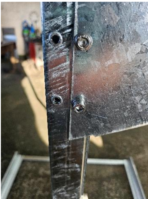
Detail der korrekt festgezogenen Verschraubung
