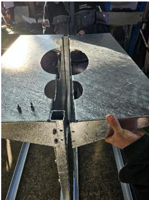
Konstruktionsbedingter Spalt vor dem Festziehen
