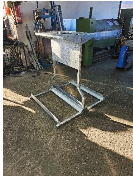
Das fertig montierte Wechselrichtergestell
